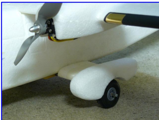
On termine le travail en découpant selon ses goûts des carénages de roues dans des chutes d'EPP. Le carénage et son prolongement jusqu'au fuselage sont collés ensemble et le tout est simplement fixé par du scotch sur les tubes de carbone du train.
