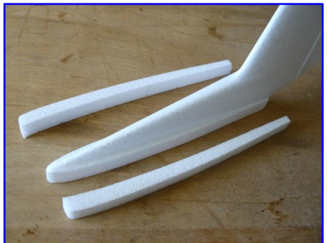
Quelques chutes d'EPP sont nécessaires pour reprendre l'assise du stabilisateur qui peut rester démontable en utilisant une vis nylon et un écrou collé sous une languette de CTP au fond du fuselage. Pour mettre en place la dérive, il faut également découper deux pièces en EPP pour reprendre la largeur manquante.
