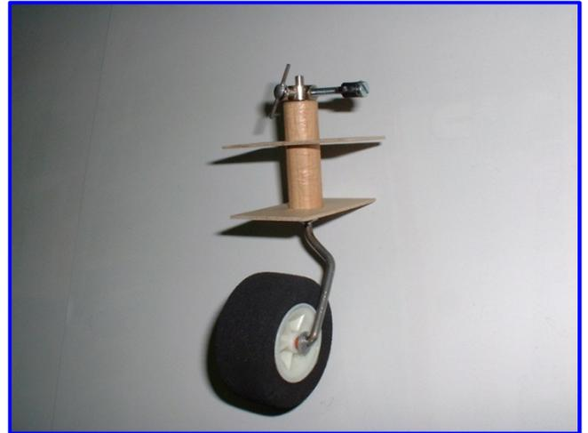
Le train avant est orientable en le reliant au servo de direction situé sous la verrière. Il est également démontable en desserrant la vis qui bloque le palonnier sur la jambe de train. Les deux plaquettes en CTP 15 / 10<sup>ème</sup> prennent en sandwich l'EPP sous le nez de l'avion et donnent donc de la solidité à la roue avant qui peut être fortement sollicitée en cas de sortie de piste.
